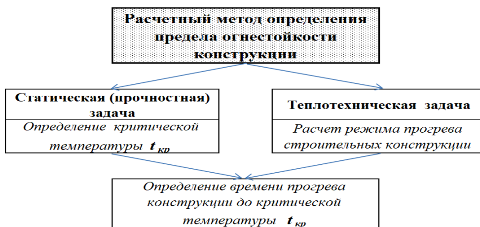
Рисунок 3.1 – Схема расчёта фактического предела огнестойкости
