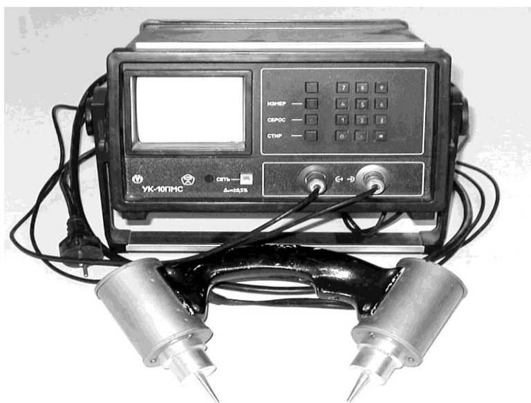
Рис.1. Ультразвуковой дефектоскоп УК-10 ПМС. (основной прибор и электроакустические преобразователи).
