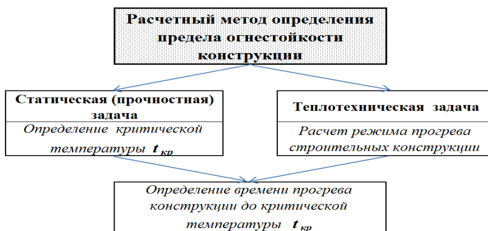
Рисунок 3.1 – Схема расчёта фактического предела огнестойкости
