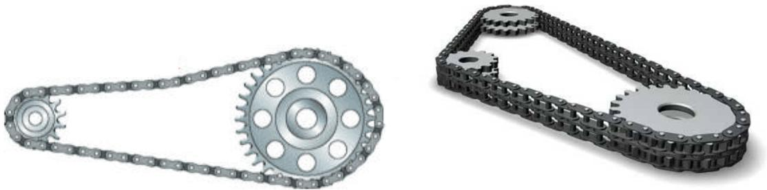
Рисунок 1.6 - Вид цепной передачи
