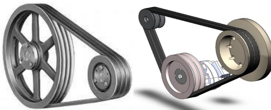
Рисунок 1.4 - Вид ременной передачи
