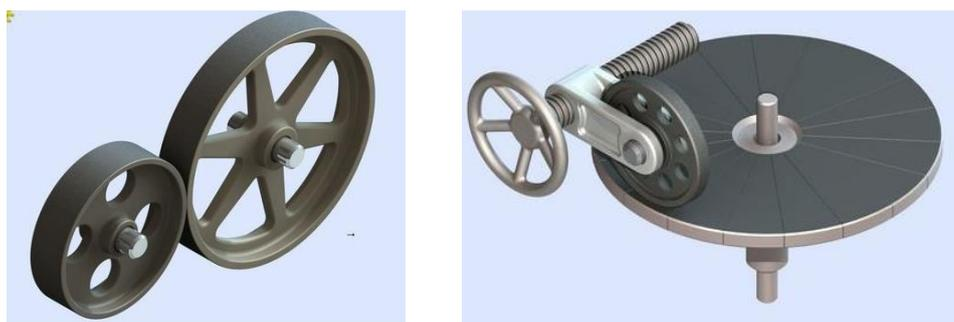
Рисунок 1.3 - Вид фрикционной передачи
