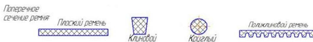
Рисунок 5.2 - Типы ремней по форме поперечного сечения
