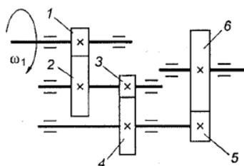
90. Определить требуемую мощность электродвигателя, если  $N_{\text{ВЫХ}}=8$  кВт;
