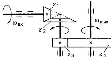
88. Для изображенной передачи определить момент на ведомом валу, если  $N_1=6$  кВт;  $\omega_2=20$  рад/с;  $\eta=0,97$ ;  $i=2,5$
