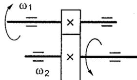
82. Для изображенной многоступенчатой передачи определить общее передаточное число, если  $\omega_1=100$  рад/с;  $\omega_2=25$  рад/с;  $\omega_3=5$  рад/с.
