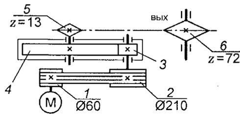
84. Для изображенной многоступенчатой передачи определить общее передаточное число, если  $d_1=50$  мм;  $d_2=200$  мм;  $d_3=35$  мм;  $d_4=70$  мм
