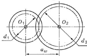
95. Определить межосевое расстояние прямозубой цилиндрической передачи, если делительный диаметр шестерни 72 мм, число зубьев колеса 90, модуль передачи 4 мм.
