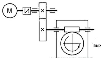
91. Определить требуемую мощность электродвигателя, если  $N_{\text{ВЫХ}}=12$  кВт;
