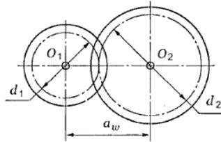
97. Определить диаметр ведущего шкива, если диаметр большего шкива  $d_2=210$  мм, частота вращения ведущего вала  $n_1=945$  мин<sup>-1</sup>, частота вращения ведомого вала  $n_2=540$  мин<sup>-1</sup>, скольжение в передаче не учитывать
