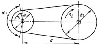
98. Определить значение окружной скорости ведущего шкива, если диаметр большего шкива  $d_2=560$  мм; угловая скорость на ведомом валу  $\omega_2=122$  рад/с; передаточное отношение 2,5; коэффициент скольжения не учитывать.
