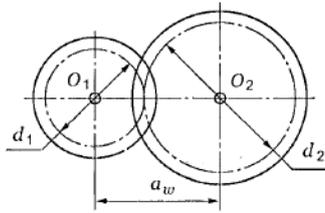
96. Рассчитать передаточное отношение передачи, если делительный диаметр шестерни 60 мм, модуль зуба 3,5 мм, число зубьев ведомого колеса 68
