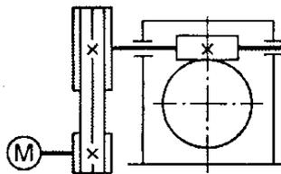
81. Для изображенной передачи определить момент на ведомом валу, если  $N_1=5$  кВт;  $\omega_1=157$  рад/с;  $\omega_2=62,8$  рад/с; КПД=0,97
