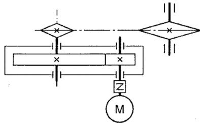
86. Для изображенной передачи определить момент на ведущем валу, если  $N_2=8,5$  кВт;  $\omega_2=12$  рад/с;  $\eta=0,96$ ;  $i=2$
