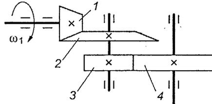
85. Определить требуемую мощность электродвигателя, если  $N_{\text{ВЫХ}}=5$  кВт;  $\eta_{\text{ред}}=0,97$ ;  $\eta_{\text{цеп}}=0,95$
