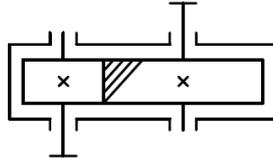
79. Определить передаточное отношение второй ступени двухступенчатой передачи, если  $\omega_{\text{вх}}=155$  рад/с,  $\omega_{\text{вых}}=20,5$  рад/с,  $z_1=18$ ,  $z_2=54$ .
