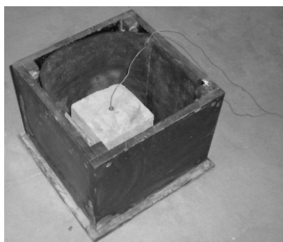
Рис. 1. Схема размещения взрываемого образца во взрывной камере
