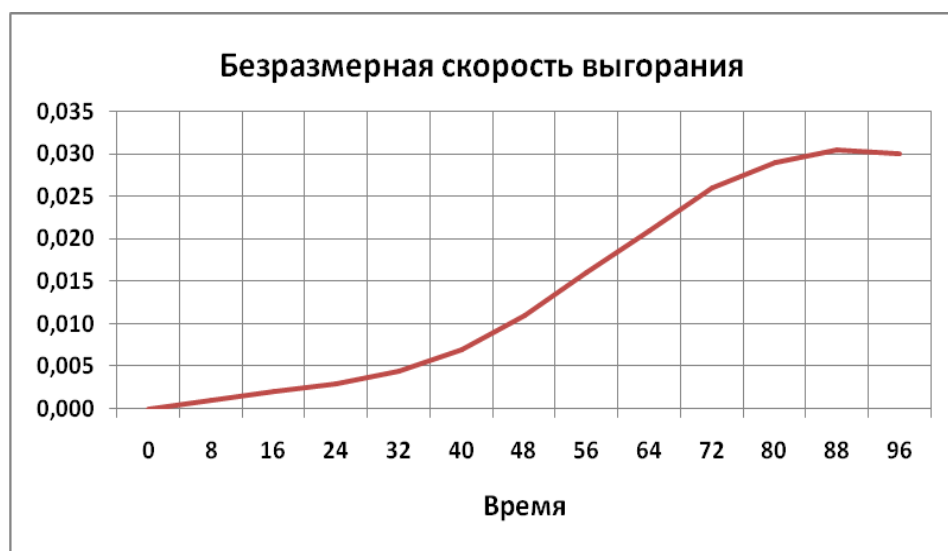
Рис. 4. Зависимость безразмерной величины скорости выгорания продуктов горения \psi от безразмерного времени \tau_B = \tau * G_0 / (\rho * V)
