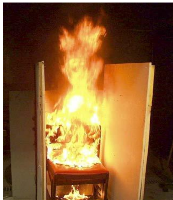
Рис. 3. Зажигание с пластиковыми коробками и интенсивное горение через 15 мин
