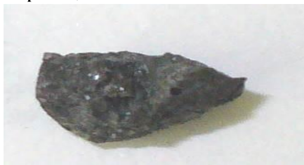
г) Сплавившийся периклаз черного цвета
