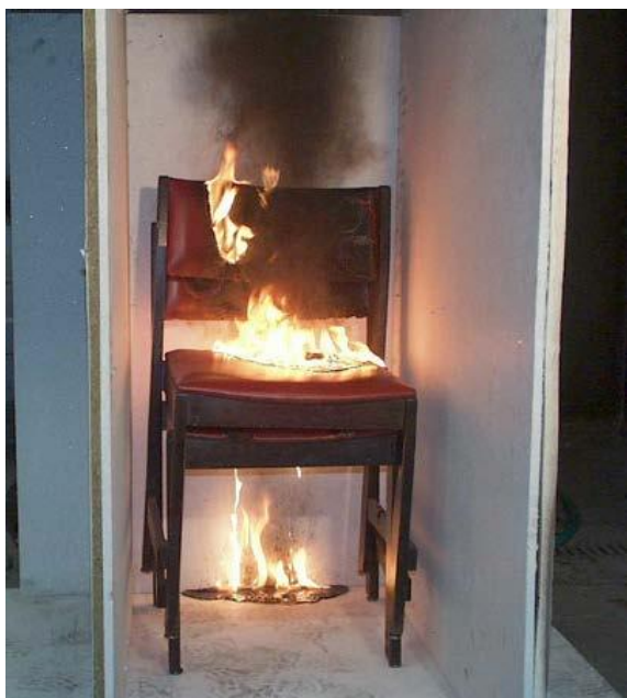
Рис. 3. Зажигание с пластиковыми коробками и интенсивное горение через 15 мин
