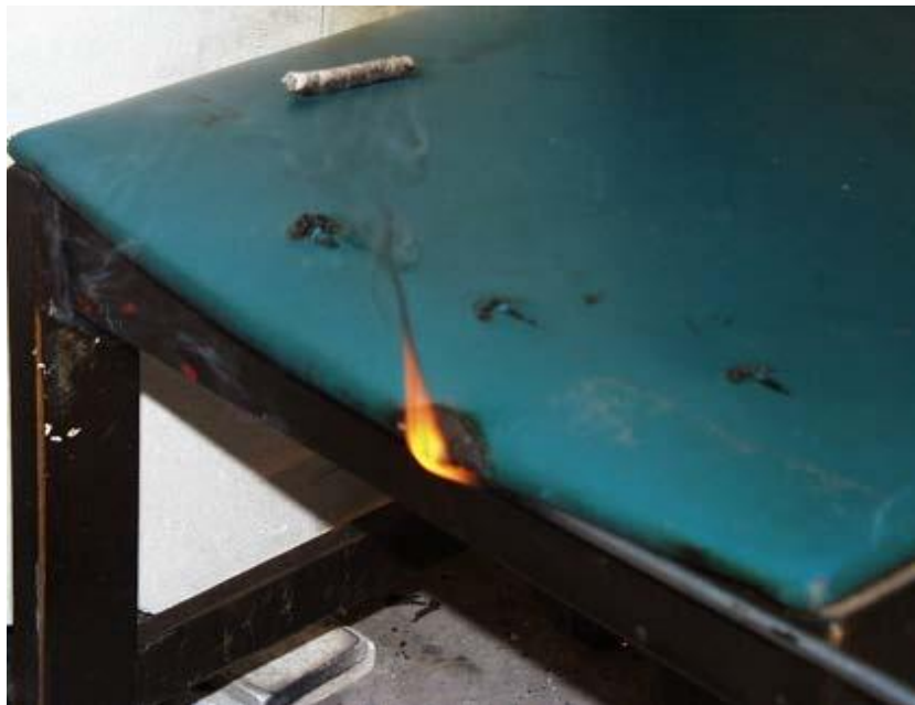
Рис. 2. Испытания. Попытка поджига сигаретой
