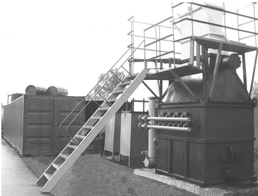
**Рис. 2. Газогенераторная энергетическая установка ГГЭУ-100
