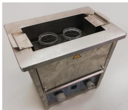
Рис. 2. Обработка ультразвуком в ультразвуковой ванне
