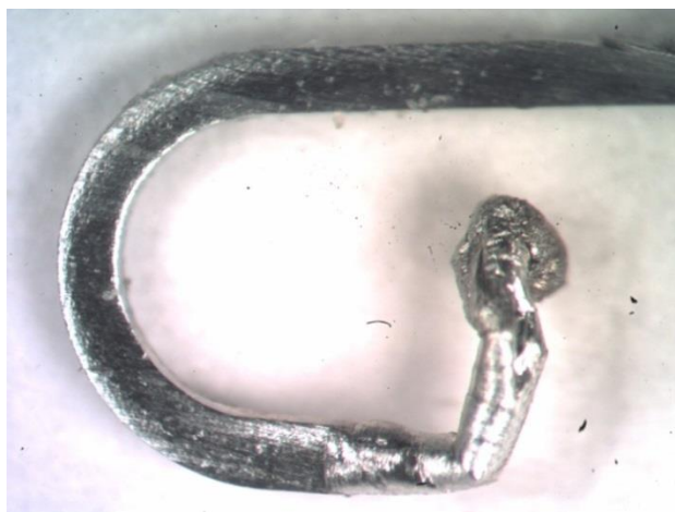
Рис. 6. Фрагмент плавкой вставки предохранителя на 5 А, подвергнутого воздействию токовой перегрузки 1,2 крат
