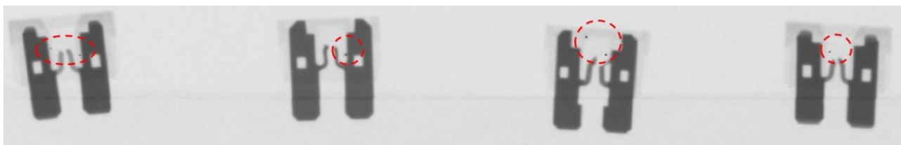
Рис. 5. Рентгеновский снимок фрагментов предохранителей, полученных в результате моделирования КЗ (красными овалами выделены шарообразные металлические частицы)
