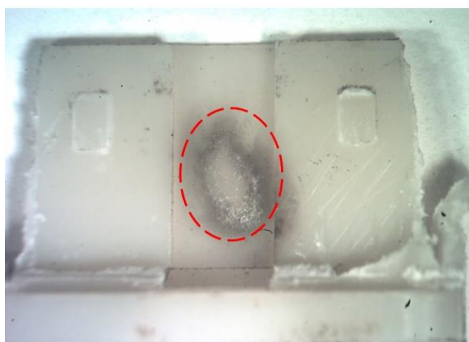
Рис. 10. Фрагмент внутренней поверхности корпуса предохранителя на 20 А, подвергнутого воздействию токовой перегрузки 3 крат (красным овалом выделен участок оплавления корпуса предохранителя)
