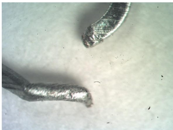
Рис. 7. Фрагмент плавкой вставки предохранителя на 7,5 А, подвергнутого воздействию токовой перегрузки 3 крат
