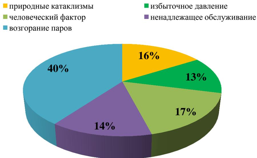
Рис. 10. Причины взрывов и пожаров при обращении нефтепродуктов в ЕС
