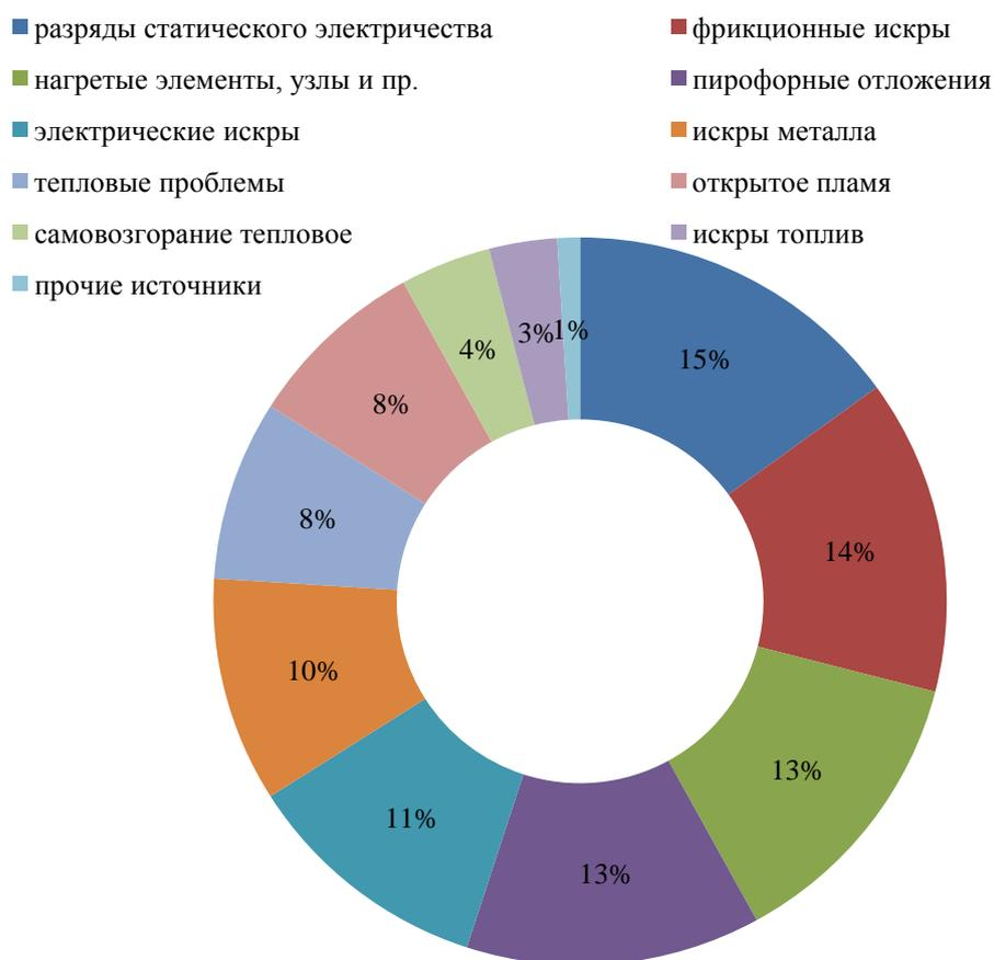
Рис. 9. Процентное соотношение взрывов и пожаров при обращении нефтепродуктов в зависимости от источников зажигания
