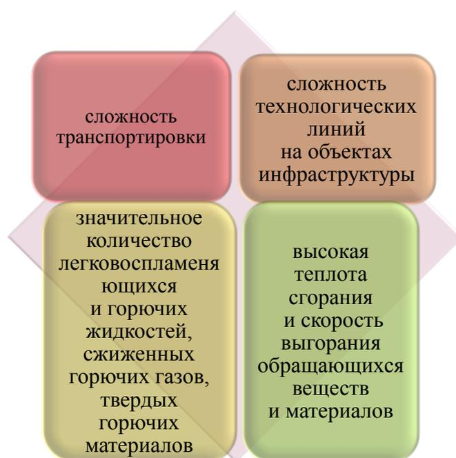
Рис. 6. Факторы, обуславливающие взрывопожарную опасность при обращении нефтепродуктов
