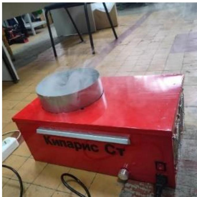
Рис. 3. Стационарный генератор искусственного дыма
