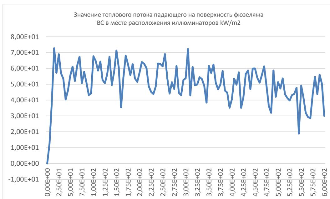
Рис. 8. Зависимость теплового потока, падающего на центральную часть фрагмента фюзеляжа воздушного судна (ВС)
