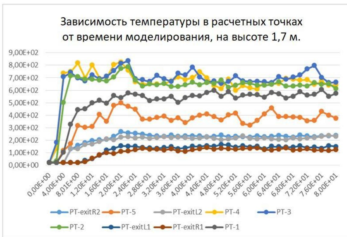
Рис. 10. Графики зависимости температуры пожара в РТ от времени моделирования
