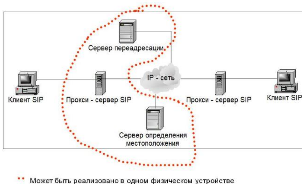
Рис. 1. Пример организации корпоративной системы связи на базе протокола SIP
