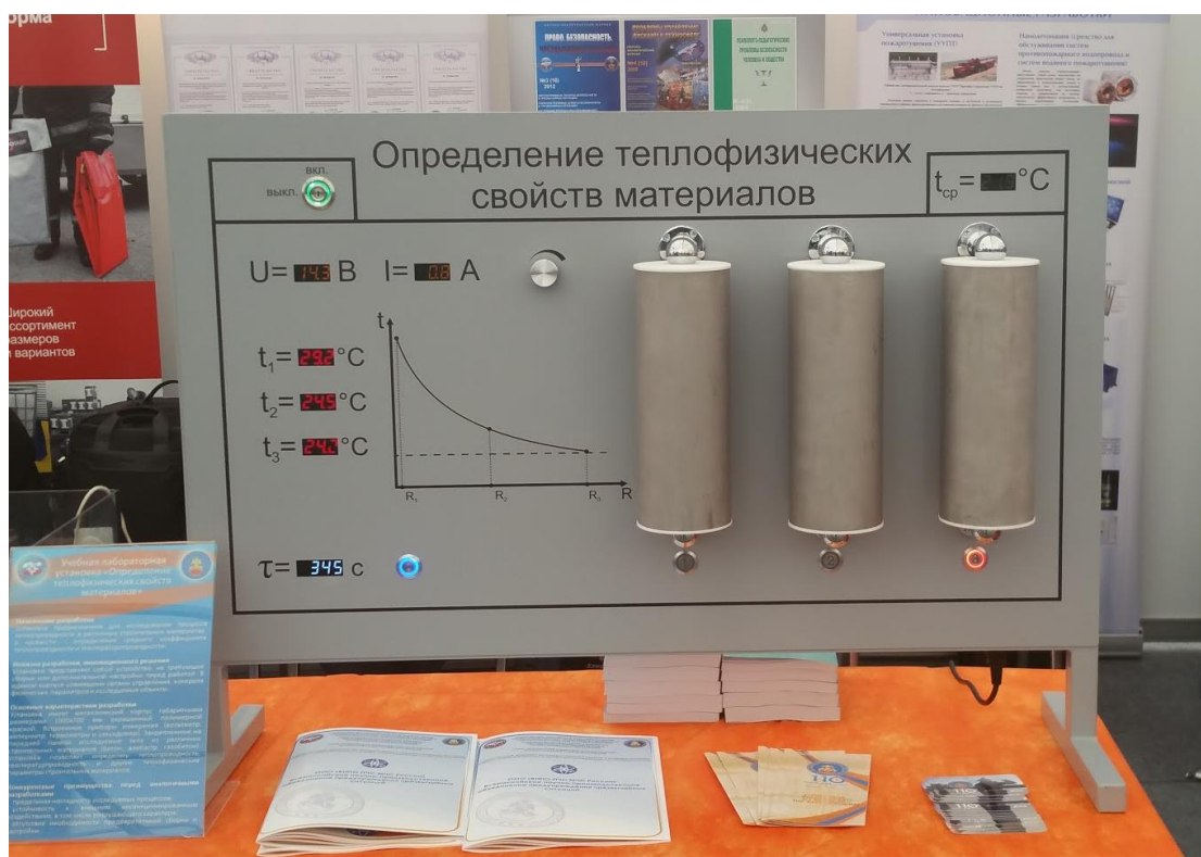
Рис. 4. Лабораторная установка «Определение теплофизических свойств материалов»
