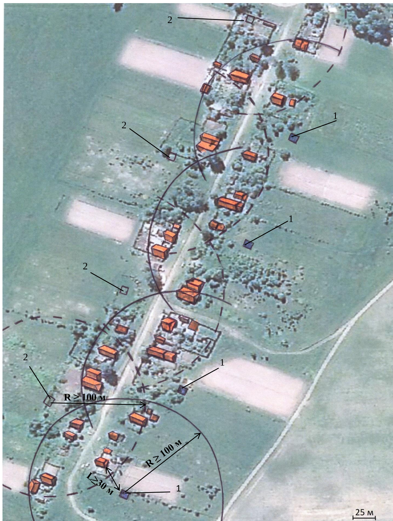
Рис. Схема размещения противопожарных водоемов в д. Айметово Советского района (вариант): 1 – основные пожарные водоемы; 2 – резервные пожарные водоемы; R – радиус обслуживания пожарным водоемом зданий; L – расстояние от точки забора воды до здания
