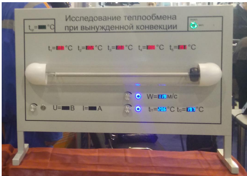
Рис. 3. Лабораторная установка «Исследование теплообмена при вынужденной конвекции»
