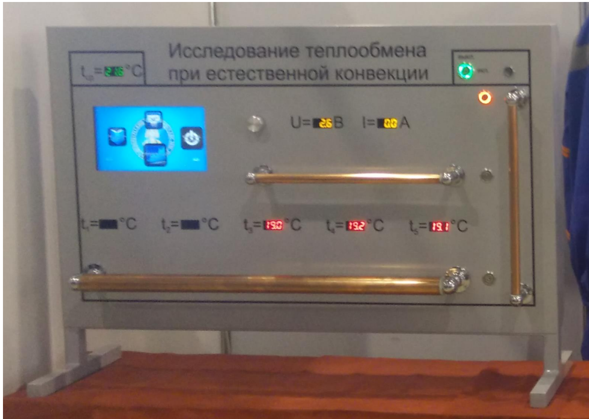
Рис. 2. Лабораторная установка «Исследование теплообмена при естественной конвекции»
