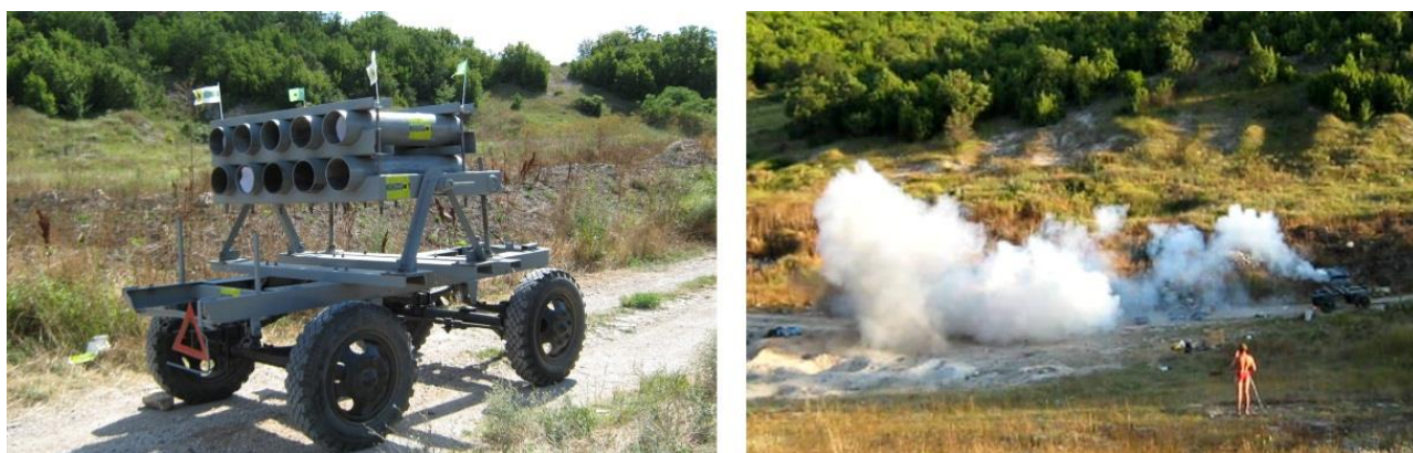
Рис. 1. Импульсно-распылительный залпом 10-ствольный модуль на лафете. Залповое распыление из пяти стволов
