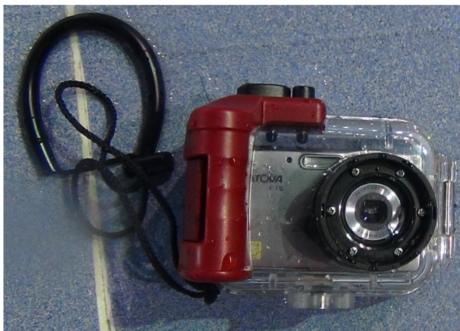
Рис. 5. Подводный бокс с фотокамерой, использованные для фото и видеозаписи при проведении занятий
