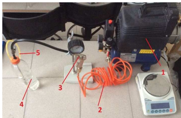
Рис. 3 Лабораторная установка для оценки эффективности тушения компактными струями воды с различными добавками
