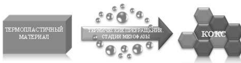
Рис.1. Условная схема термической деструкции термопластичных материалов
