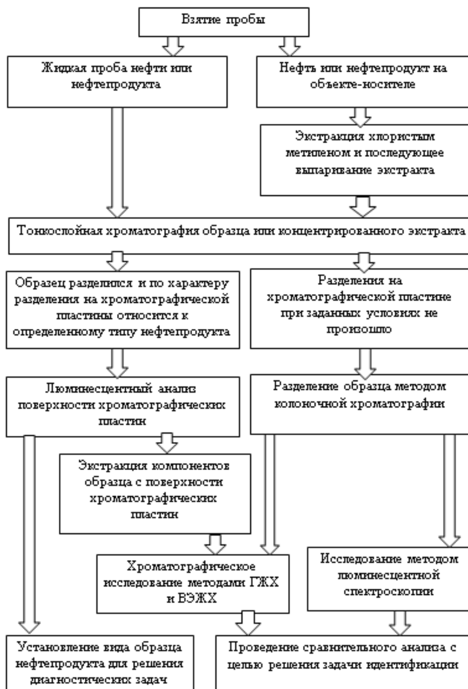
Рис. 1. Алгоритм проведения исследования нефтяных загрязнений, включающий этап предварительного разделения
