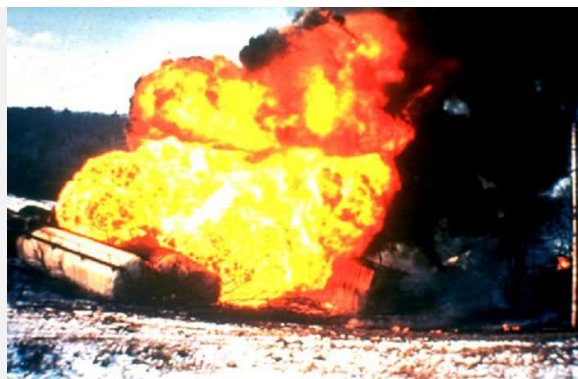
Рисунок 5 – Взрыв емкости с СУГ
