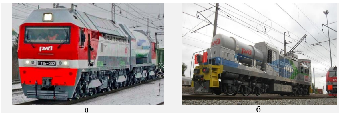
Рисунок 1– Газотурбовоз – GT1h-002 магистральный модульный (а) и газотепловоз ТЭМ19 – тепловоз экономичный маневровый (б)
