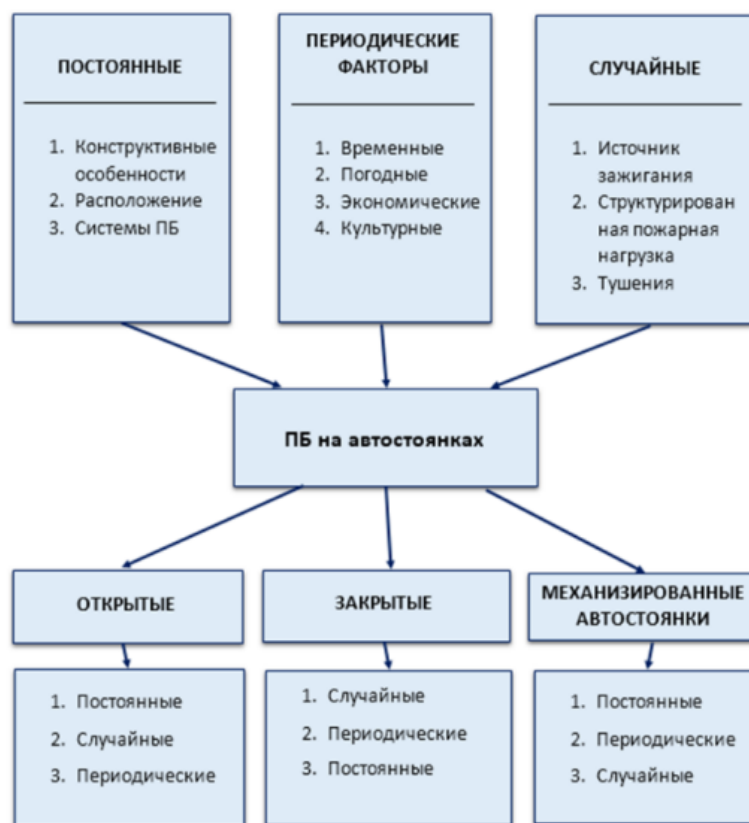
Рисунок 1 – Факторы, влияющих на возникновение и развитие пожаров на объектах хранения автотранспорта
