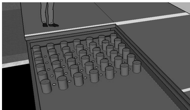
Рисунок 2 – Монтаж дорожного покрытия. Вариант размещения опор
