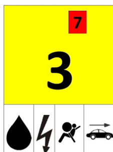
Рисунок 3 – Сортировка и маркировка, в случае большого количества пострадавших или поврежденных транспортных средств
