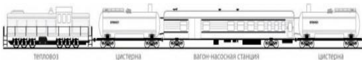
Рисунок 1 – Состав пожарного поезда 2-й категории (тепловоз не входит в штатный состав поезда)
