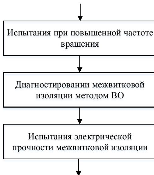
*Рисунок 5 – Фрагмент технологии испытаний ТЭД типа ТЛ-2К*
