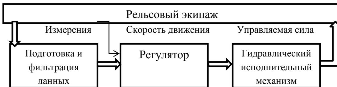
Рисунок 2 – Структурная схема колесно-рельсовой системы с компьютеризированным активным исполнительным механизмом
