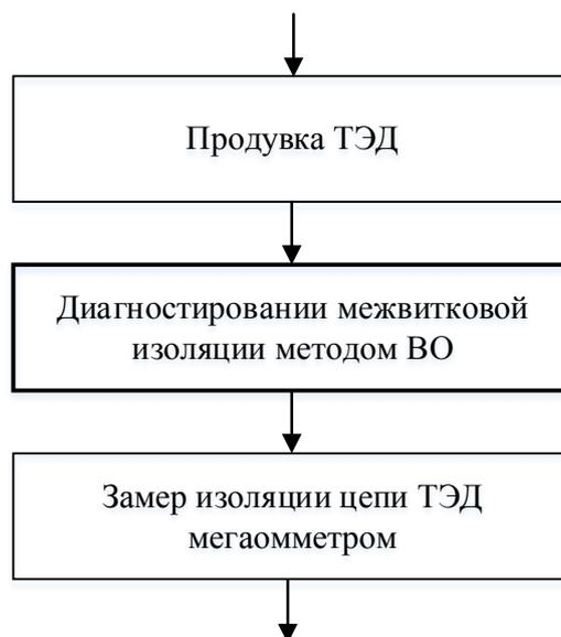
*Рисунок 4 – Фрагмент технологии ремонта ТЭД типа ТЛ-2К*
