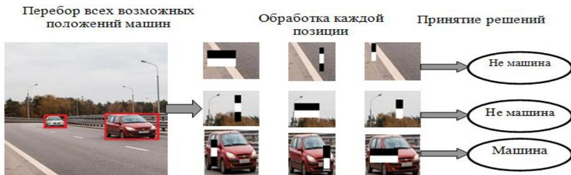
Рисунок 2 – Схема работы сканирующего окна
