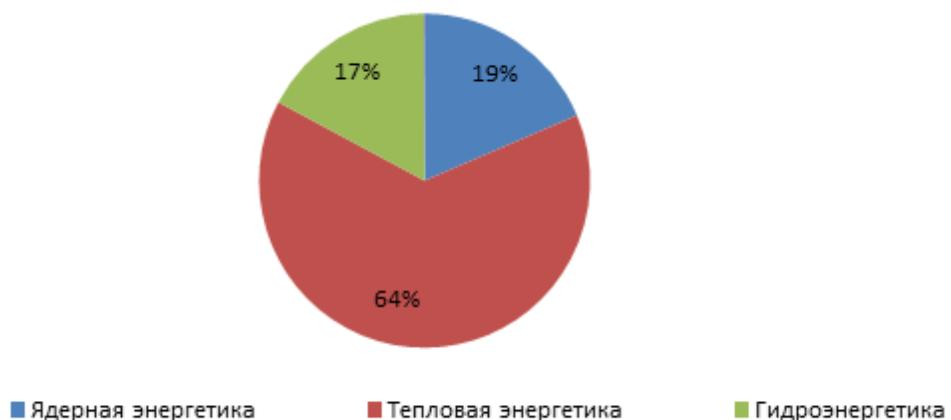
Рисунок 1 – Структура производства электроэнергии в России за 2017 год
