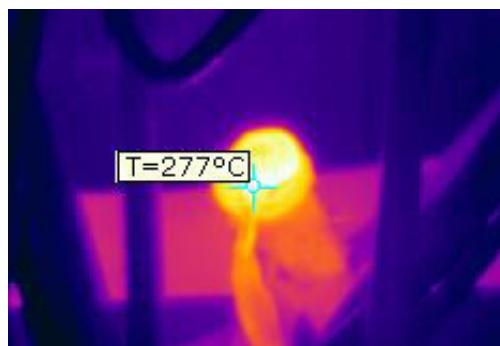
Рисунок 2 – Разогрев болтового контактного соединения на шине заземления в щите ввода квалифицируется как пожароопасный дефект. Требует немедленного устранения
