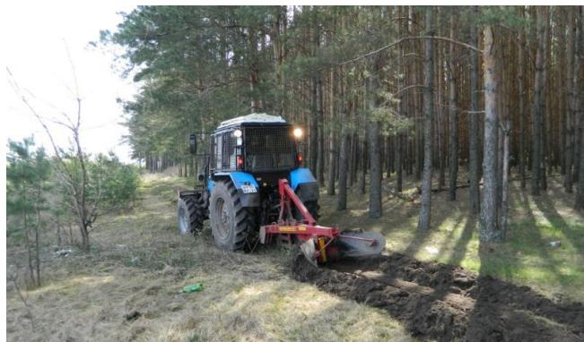
Рисунок 4 – Прокладка заградительных минерализованных полос и канав
