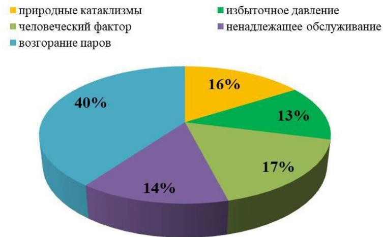
Рисунок 6 – Причины взрывов и пожаров при обращении нефтепродуктов в ЕС
