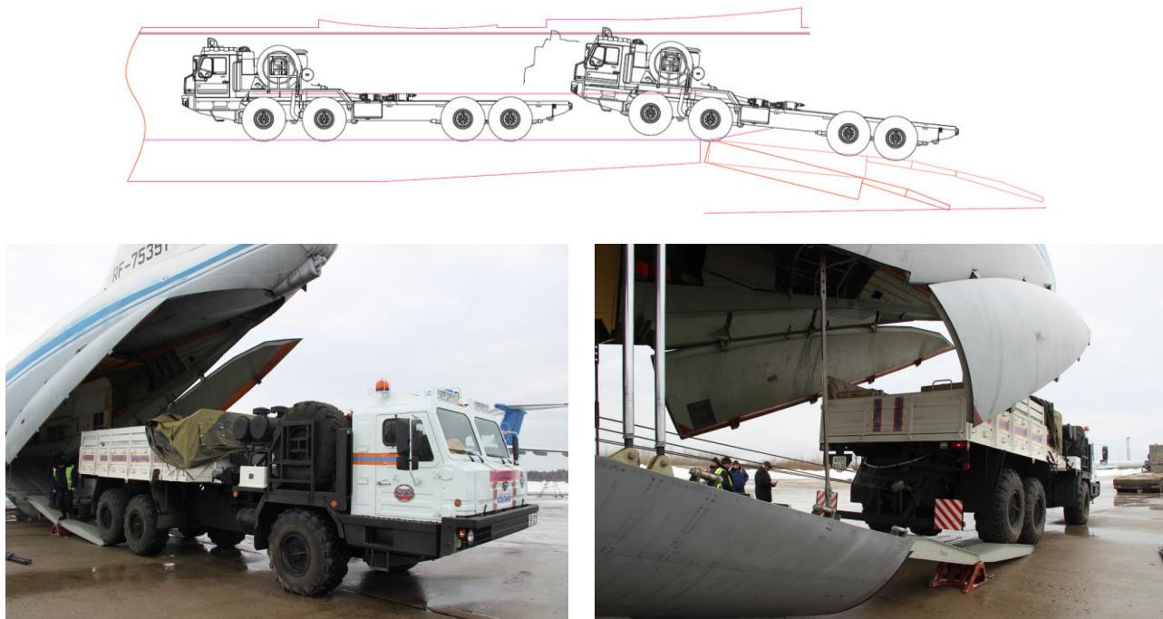
Рисунок 2 – Транспортировка самолётом Ил-76 в «Арктический» БАЗ-69092
