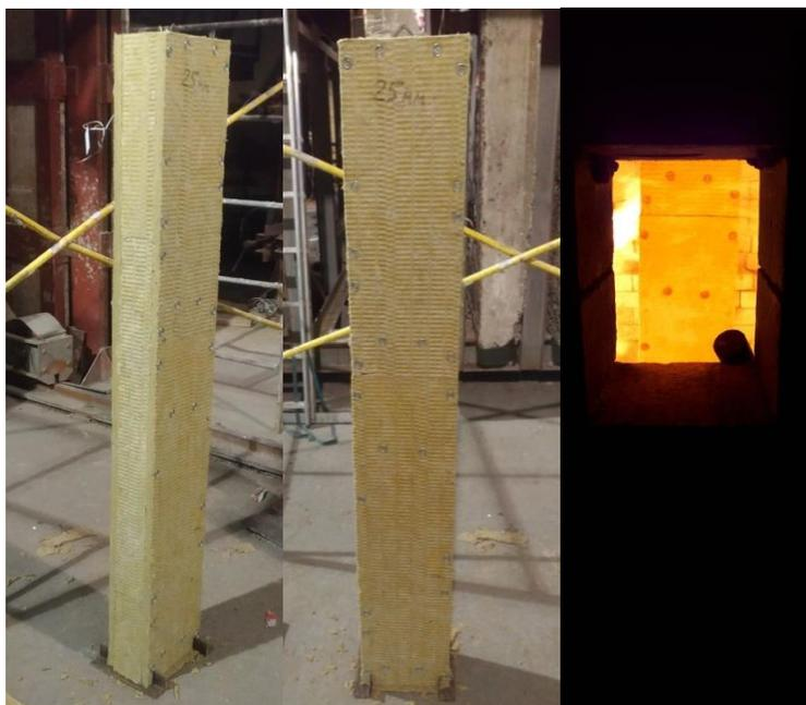
Рисунок 5 – Минераловатные плиты на спиральном крепеже
