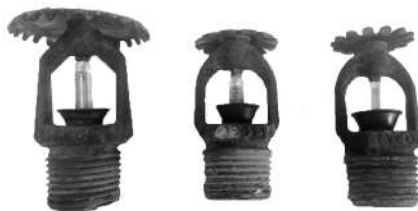
Рис. 3. Оросители зарубежного производства после испытаний
