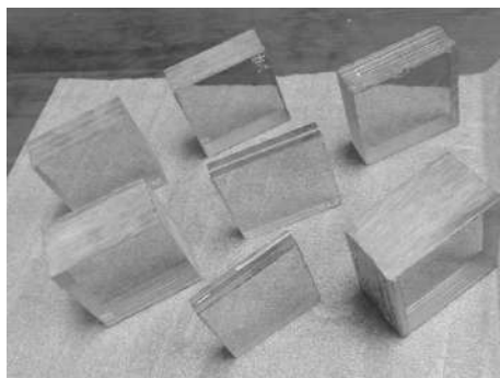
Рис. 1. Исследуемые образцы броневых стекол. Подготовлены в ЗАО «НПО СМ»
