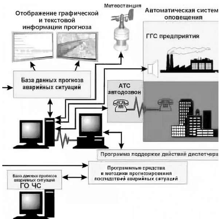
Рис. 3. Автоматизированные системы контроля аварий и оповещения
