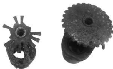
Рис. 2. Оросители отечественного производства после испытаний в аммиачной среде
