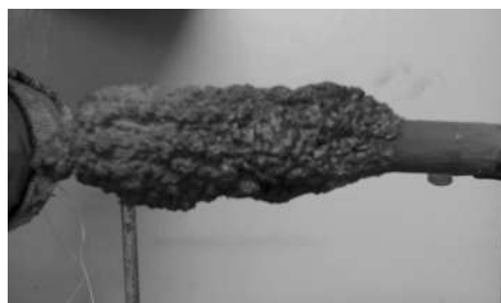
Рис. 2. Образование пенококса при нагреве покрытия № 5 с добавкой корундовых микрочастиц
